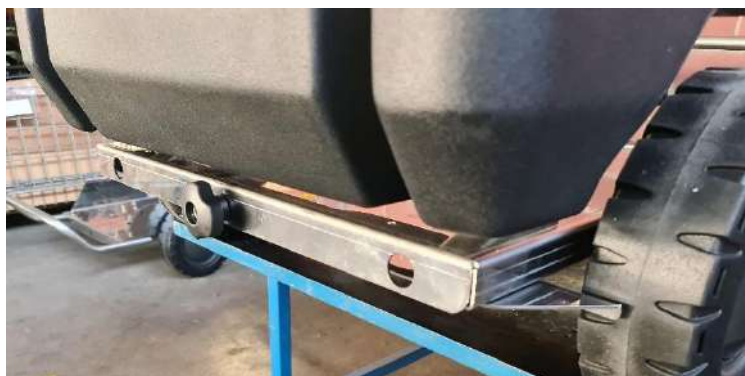
Detalle del pomo de freno bloqueado en el eje trasero
